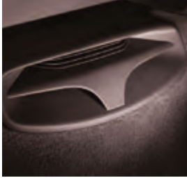
4) Basluidspreker met 10,2 cm x 15,3 cm in een 6-liter basreflexbehuizing
